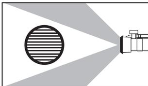
Разделяет струю на две, что позволяет обрабатывать два ряда растений одновременно.
